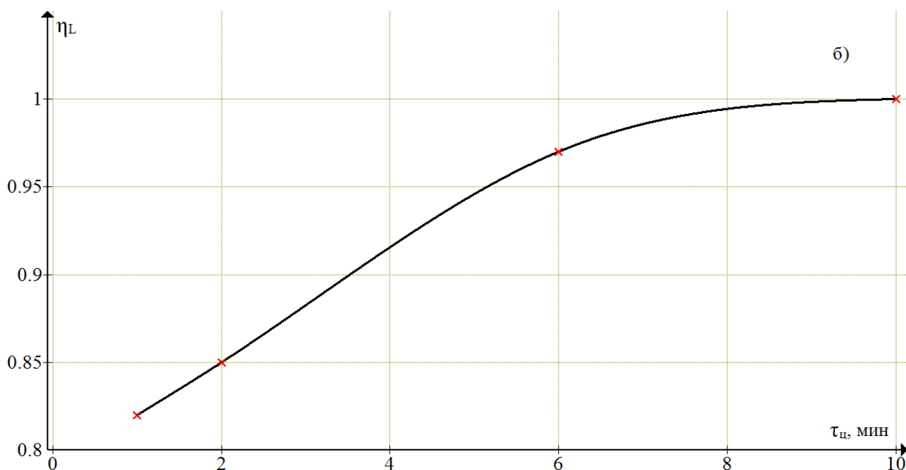
Сурет 25. Аналық ерітіндінің шоғырлану дәрежесінің және мақсатты затты алу коэффициентінің (Б) айыру кезеңінің ұзақтығына тәуелділігі (сүт өнідері: \tau_{ц}=2000 айн/мин)
